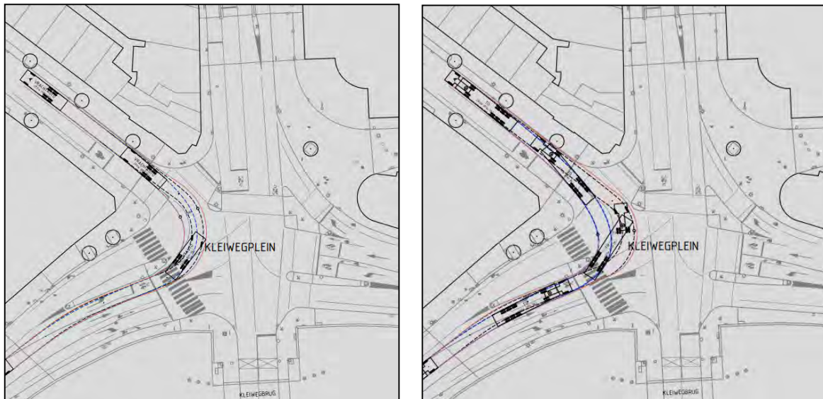
Figuur 11 en 12: rijcurvensimulatie solowagen / truck met oplegger linksaf vanaf Kattensingel
