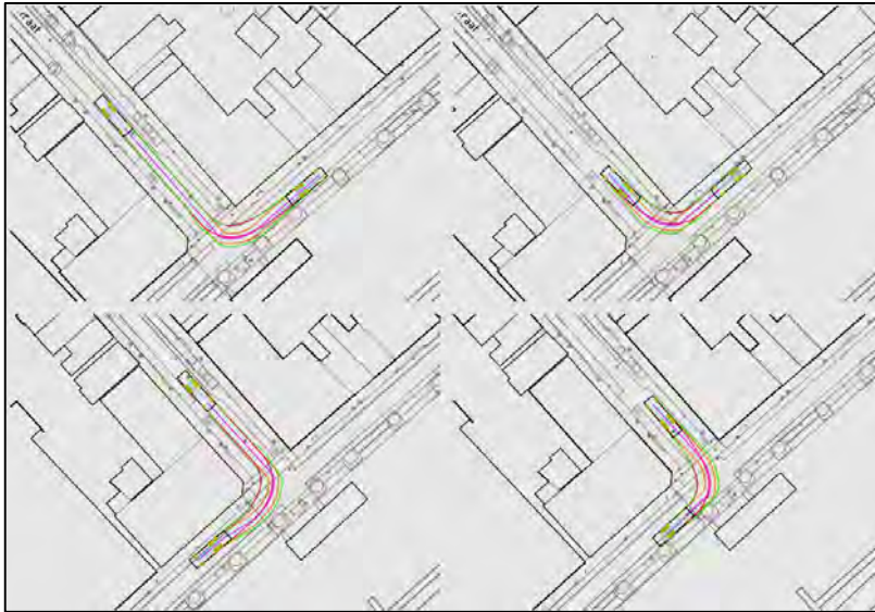
Figuur 27: Rijcurven vrachtwagen aansluiting Crabethstraat op Kattensingel
