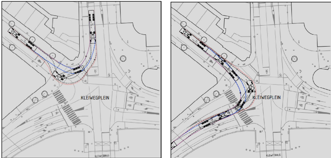
Kleiwegplein rijcurvensimulatie vrachtwagen (solowagen)
