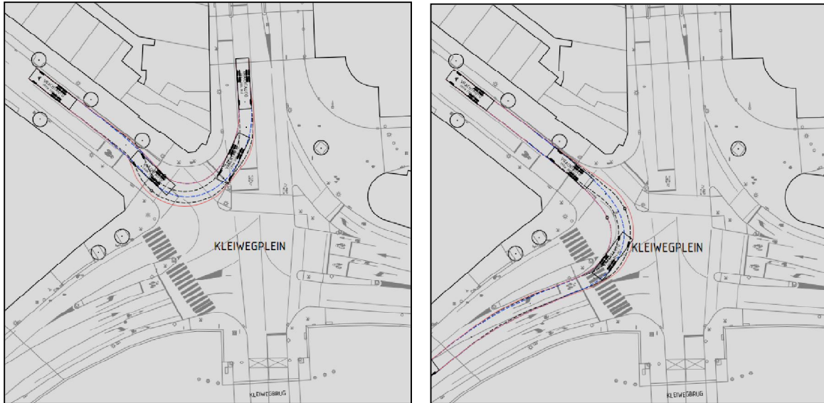
Kleiwegplein rijcurvensimulatie vrachtwagen (solowagen)
