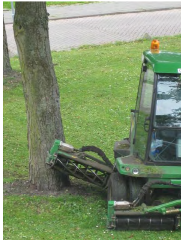
Schade aan bomen bij maaien
